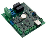
LAN door controller
