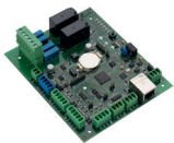
LAN door controller
